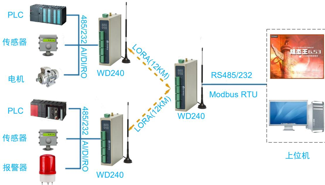
■ 上位机通过 LORA 读取 WD240 的 IO 和下挂的 PLC 数据
