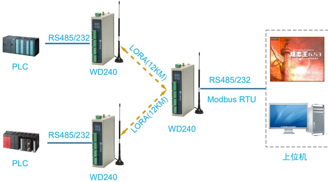
■ 云平台通过 LORA 无线和互联网方式读取 WD240 的 IO 和下挂的 PLC 数据
