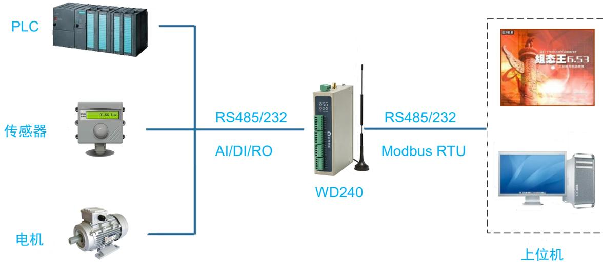
■ 上位机通过 LORA 无线方式读取 WD240（下位机）的 IO；
