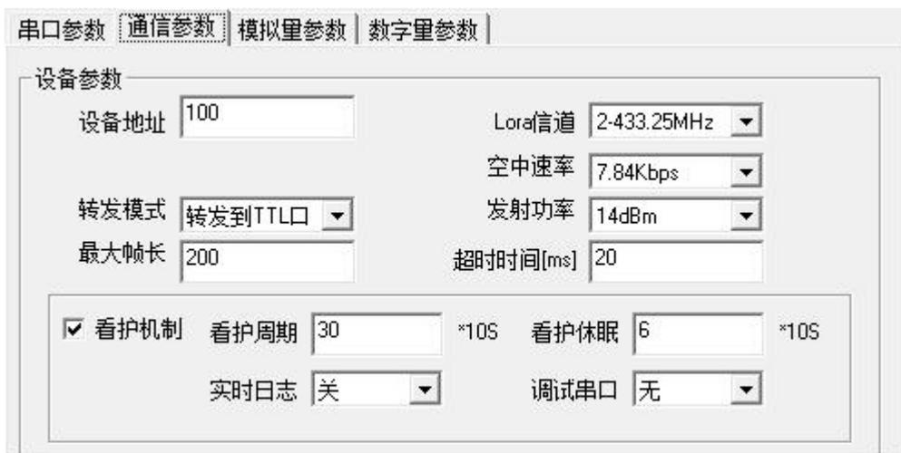
**设备地址：**是 WD140 最为采集模块的时候，支持 modbus 访问和控制 IO 数据，该设备地址为本机采集模块的 modbus 的从站地址。
