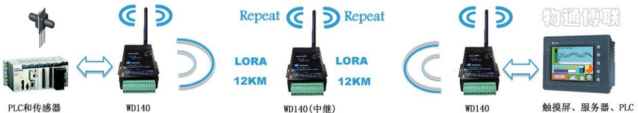
(4) 上位机、云平台通过 LORA 无线和互联网方式读取 WD140 的 IO 和下挂的 PLC 数据
